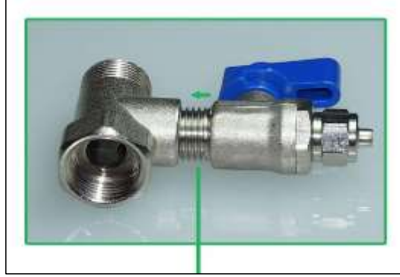
1/4 küresel vananın işaretli kısmını teflon band saralım ve hatalmayı yerine taktıktan sonra küresel vanayı hatalmaya takalım.
